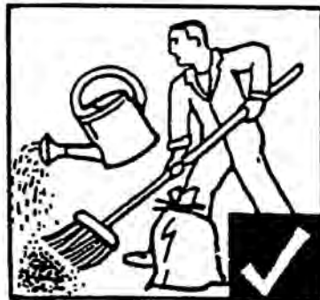
Antes de recolectar el polvo del proceso, se debe mojar el polvo, debe ser recolectado. Debe ser adecuadamente depositada en contenedores sellados y depositados conforme a las determinaciones de las reglamentaciones.
